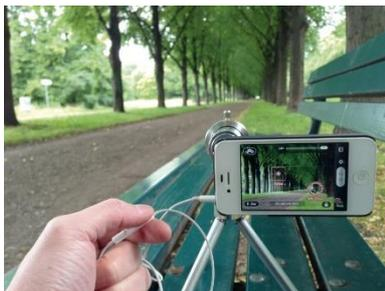
Gegen Verwacklungen hilft es zwar, das Smartphone irgendwo abzustellen oder auf einem Stativ zu montieren. Doch selbst dann kann das Auslösen per Fingertipp das Gerät in Bewegung versetzen. Abhilfe schafft eine Fernbedienung. Dazu eignet sich ein normales Kabel-Headset mit Lautstärketasten. Durch Drücken der Plus-Taste am Ohrhörer-Kabel löst man die Aufnahme aus. Viele Hersteller von Selfie-Sticks, Smartphone-Griffen oder Panorama-Stativköpfen legen Bluetooth-Fernbedienungen bei.
