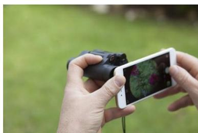
Wer noch Opas Feldstecher auf dem Dachboden liegen hat, kann diesen als Behelfs-Teleobjektiv verwenden. Mit etwas Übung genügt es dabei schon, einfach die Smartphone-Kamera an eines der Okulare zu halten.
