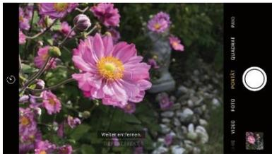
Smartphones mit Dualcams können aus den Daten beider Kameras einen guten Unschärfe-Effekt erzeugen. Dazu muss der Abstand zum Motiv innerhalb eines bestimmten Bereichs liegen, beim iPhone liegt er beispielsweise zwischen 0,3 und 2,4 Meter. Je weiter Sie entfernt sind, desto sanfter verläuft die Unschärfe.
